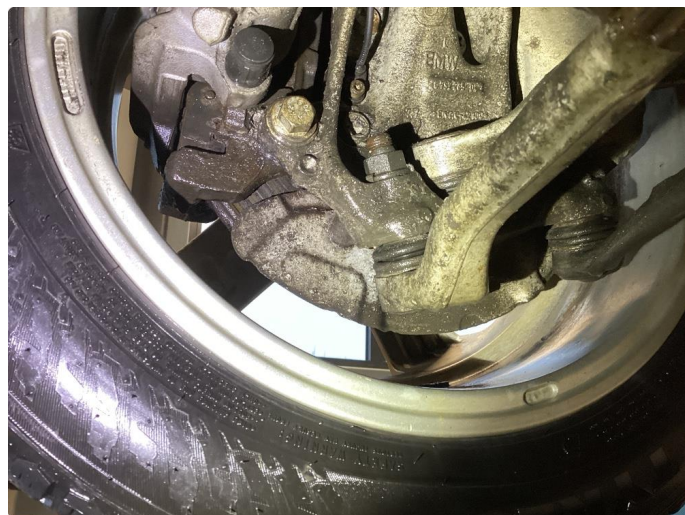
2.1 Påbegynt slitasje skiver forran
