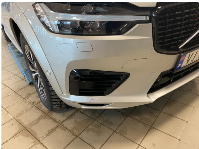
1.2 Støtfanger foran lakkert pga steinsprut slitasje
