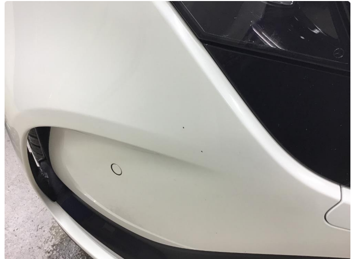
1.3 Noe steinsprut, normal bruksslitasje
