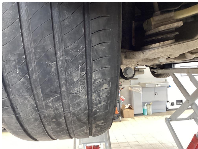
1.2 Skjev slitasje på sommerdekk, blir byttet
