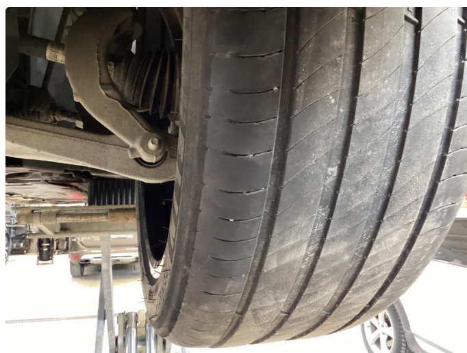
1.2 Skjev slitasje på sommerdekk, blir byttet
