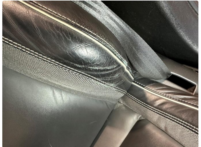
2.1 Litt slitasje på insteg sete rygg fører side
