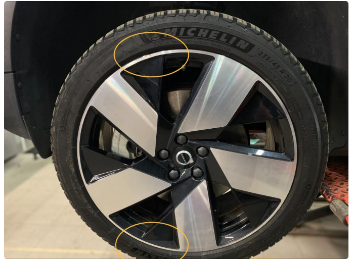
1.3 Venstre framfelg er litt kantkjørt
