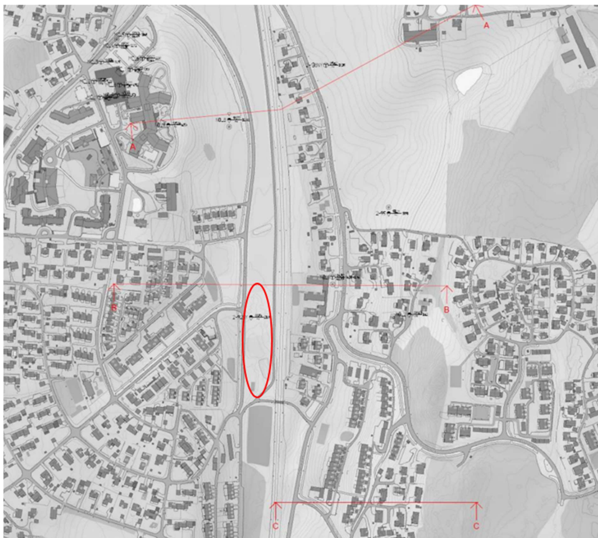
Figur 4 Beliggenhet av beregnede stabilitetsprofiler i Norconsults rapport [2]. Profil A og B er aktuelle for vurderinger knyttet til tomten. Plassering av tomt er skissert med rødt.
