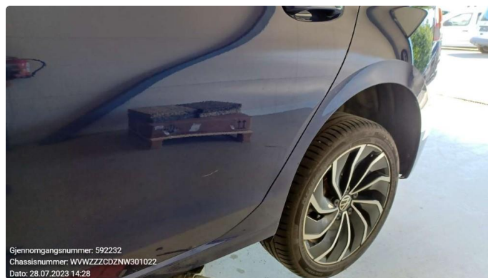
1.2 Ripe ned til grunning
