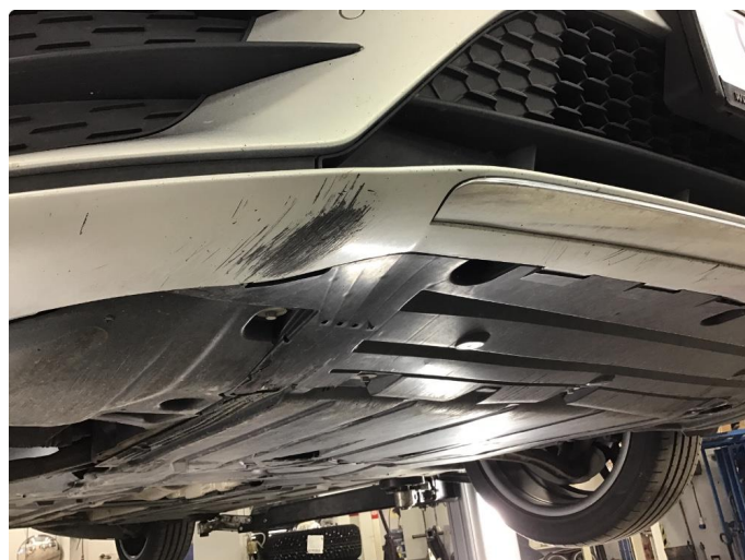
1.4 Skrubbskader i underkant av støtfanger
