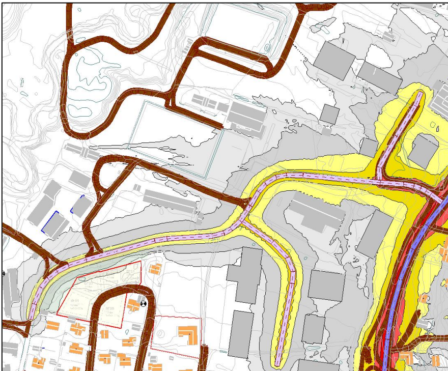
Bilde 52: Beregnede støynivåer i fremtidig situasjon med ny bebyggelse (1,5m over terreng)
