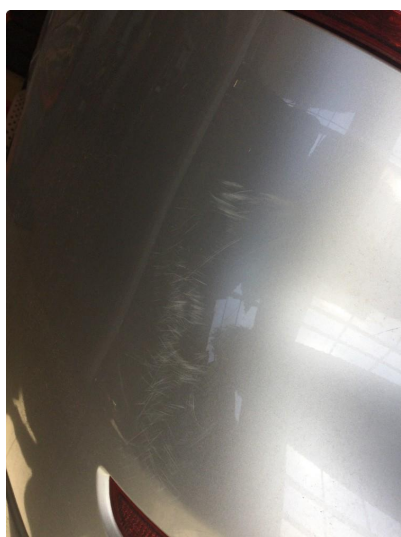
1.3 Ripe(r) ned til grunning
