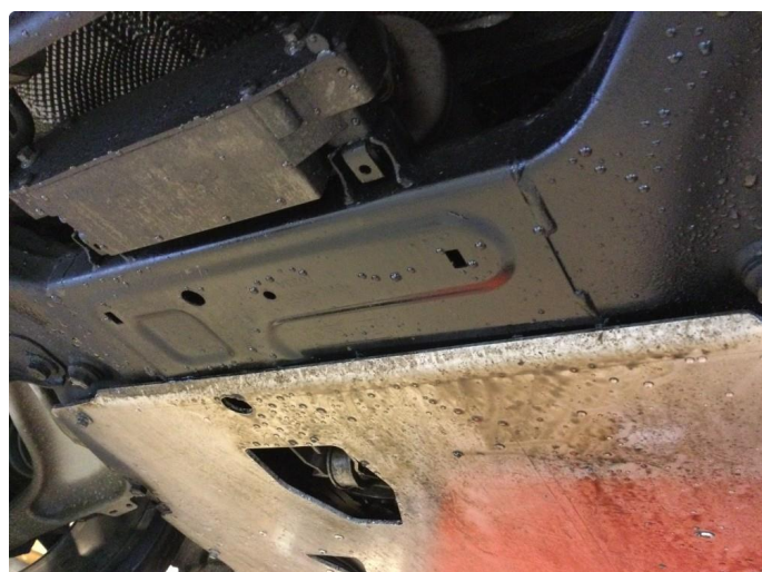
4.2 Oljelekkasje fra motor
