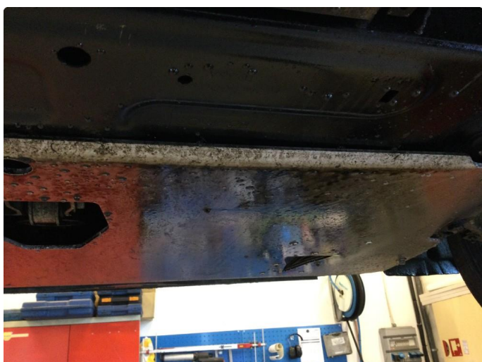
4.2 Oljelekkasje fra motor
