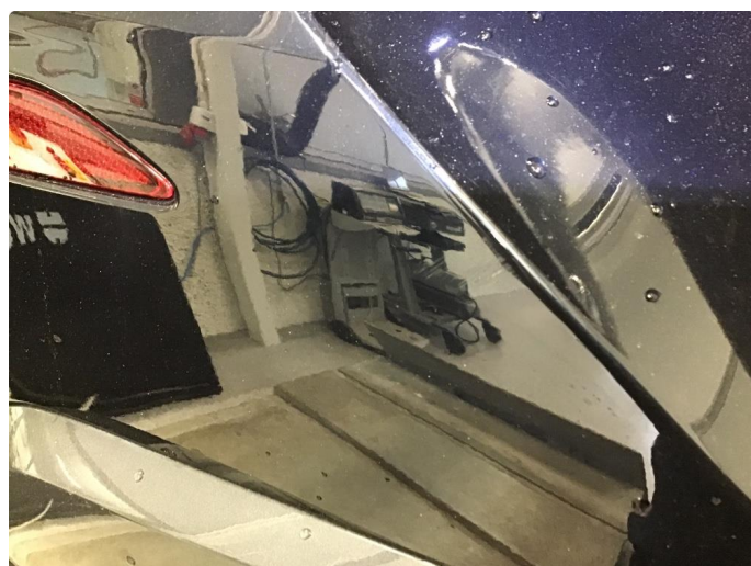
1.5 Ripe(r) ned til grunning
