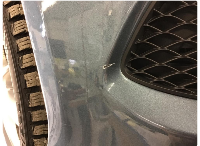
1.3 Mindre ripe/skade i støtfanger
