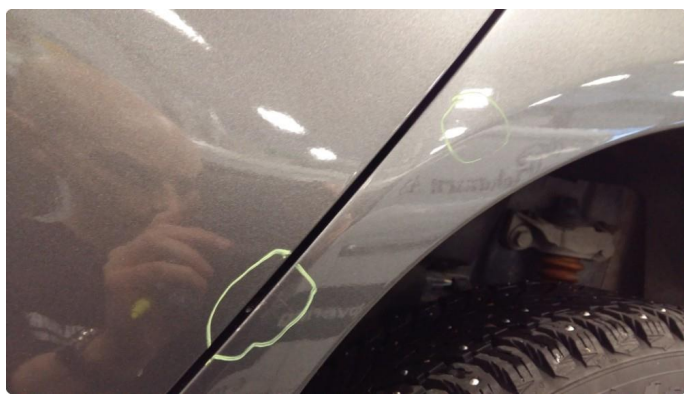
10 Noen riper og småbulker
