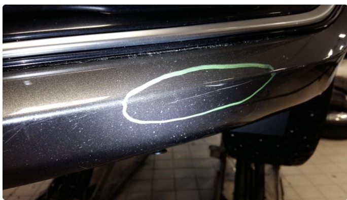
13 Ripe(r) ned til grunning
