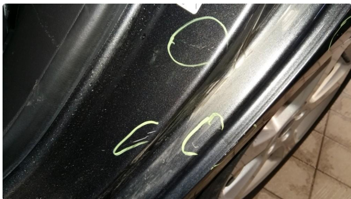
10 Noen riper og småbulker
