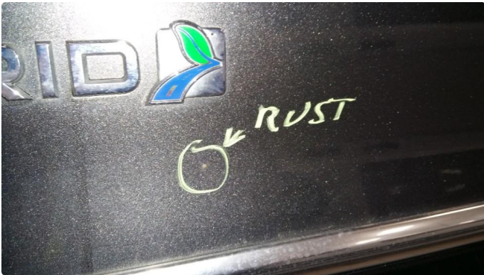
4 Steinsprut med rust
