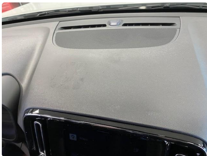
13 Skadet/merker etter utstyr
