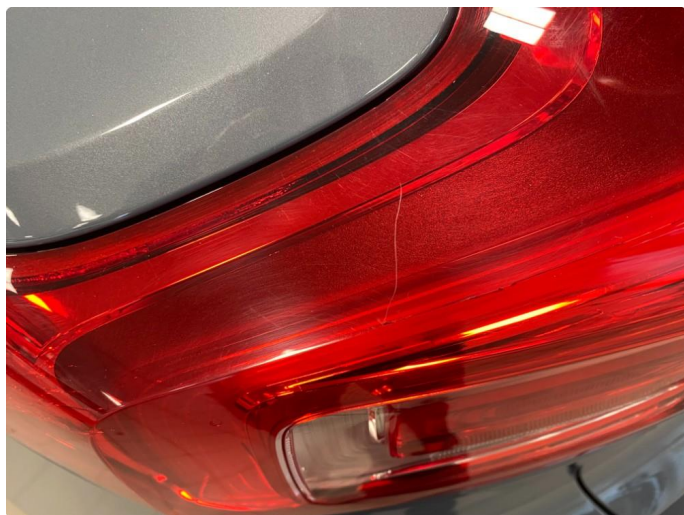
10 Defekt / sprukket glass
