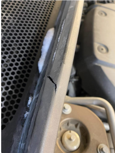
1.1 Liten sprekk i pakning rundt panseret
