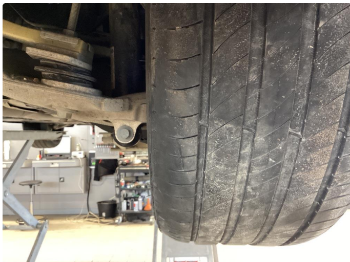
1.2 Skjev slitasje på sommerdekk, blir byttet
