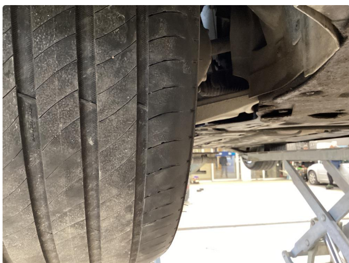
1.2 Skjev slitasje på sommerdekk, blir byttet
