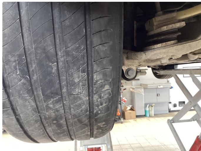
1.2 Skjev slitasje på sommerdekk, blir byttet
