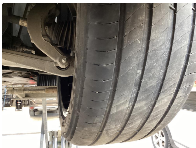
1.2 Skjev slitasje på sommerdekk, blir byttet
