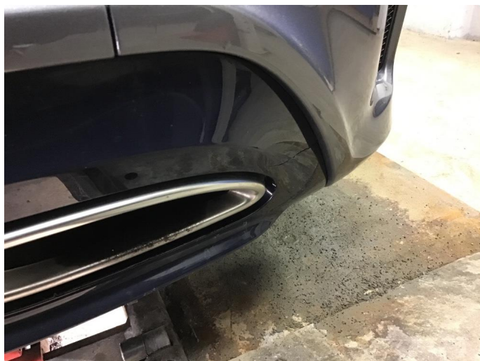
1.7 Liten sprekk i støtfanger bak
