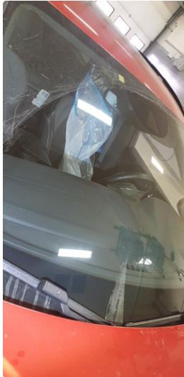
1.2 Noe steinsprut i frontrute
