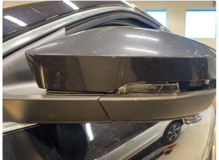
2.2 Speilhus skadet-byttes før salg
