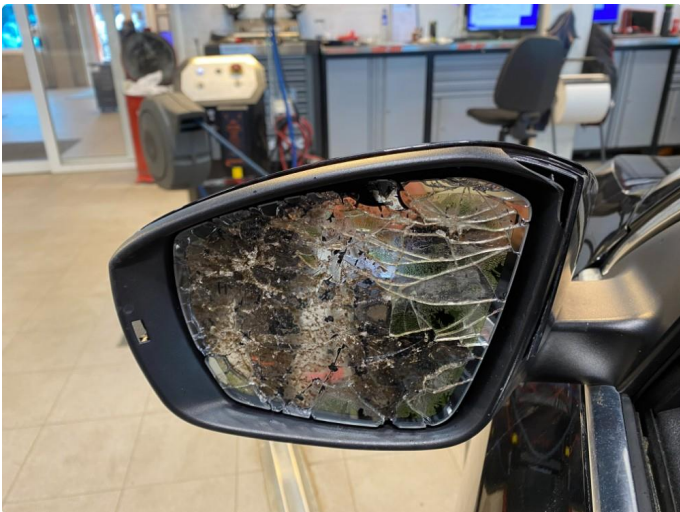
2.2 Speilhus skadet-byttes før salg
