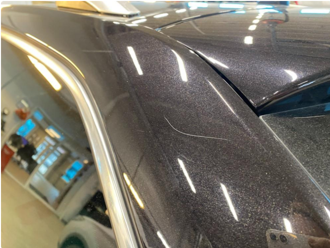
2.1 Noen riper og småbulker
