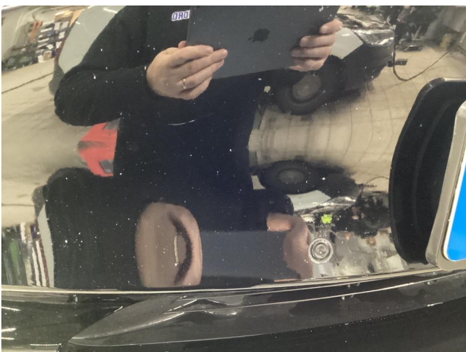
1.3 Steisprang, Normal bruktslitasje
