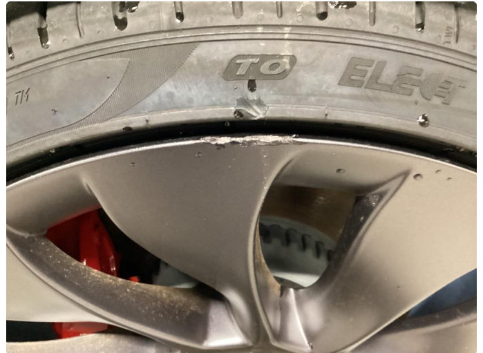
1.2 Høyre foran felg er kantkjørt
