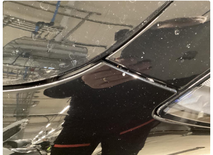
1.3 Steisprang, Normal bruktslitasje
