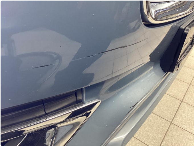
1.1 Ripe(r) ned til grunning, Støtfanger blir byttet
