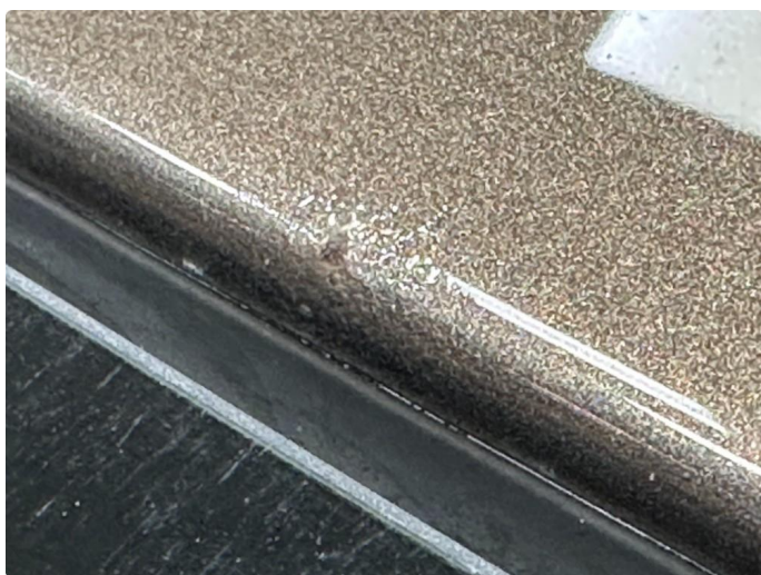
1.4 Liten steinsprut med rust i forkant takk. Pusses og lakkeres forenklet
