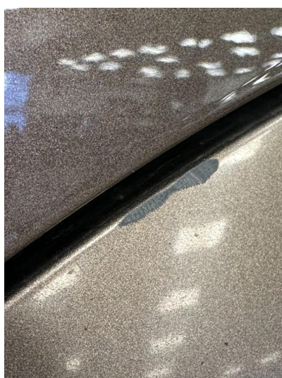
1.3 Liten lakkskade på skjermutbygger venstre bak. Lakkeres forenklet
