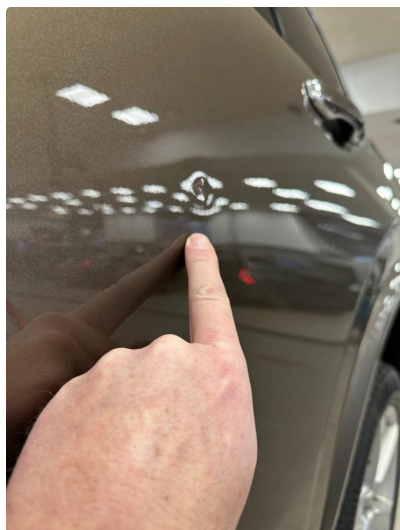
1.1 Liten bulk med lakkskade på dør venstre bak
