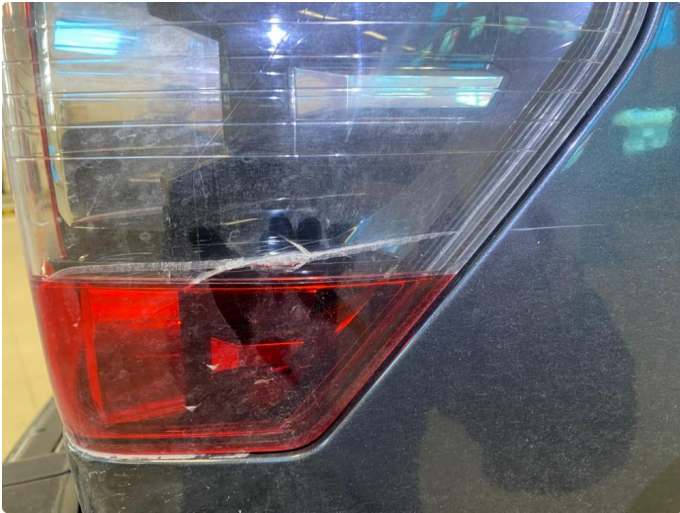
2.1 Liten sprekk i lykt
