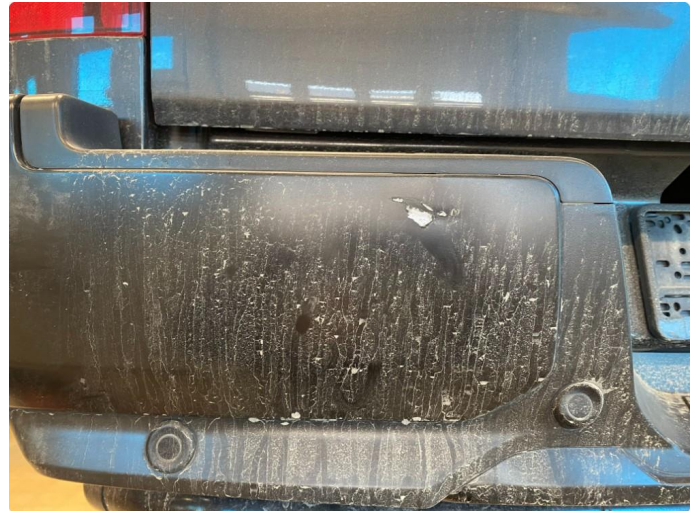
1.3 Skade i plaststøtfanger
