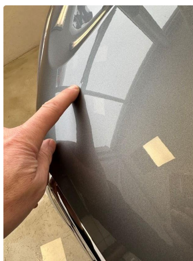
1.2 Liten ubetydelig bulk på panser høyre side
