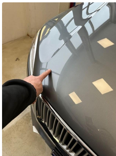
1.2 Liten ubetydelig bulk på panser høyre side
