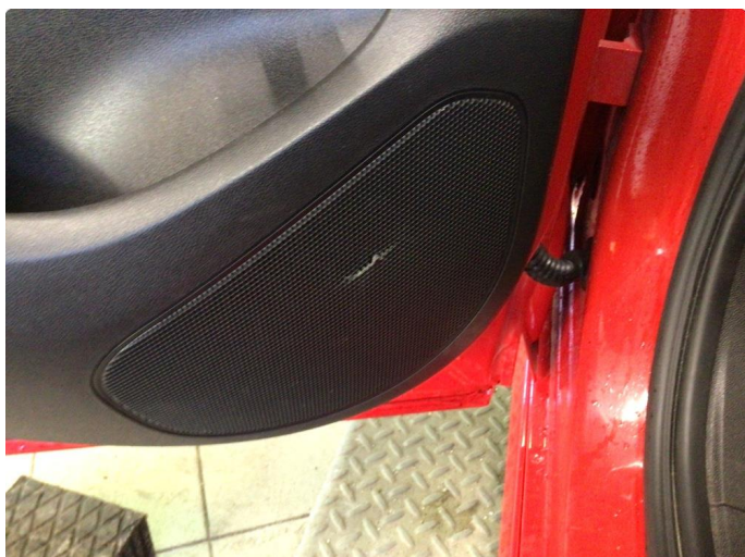
2.1 Høytaler deksel skadet
