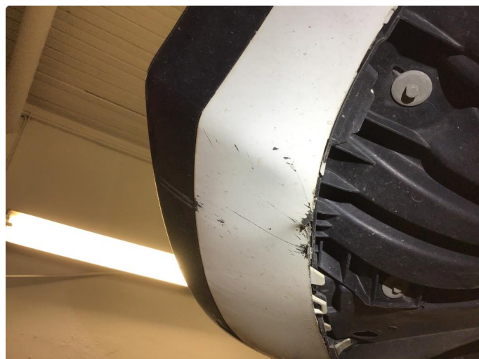
1.2 Normal bruksslitasje. Mindre riper under fanger foran.
