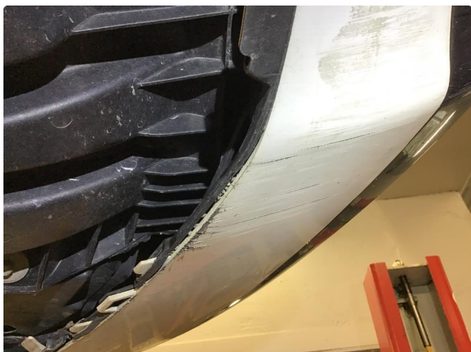
1.2 Normal bruksslitasje. Mindre riper under fanger foran.
