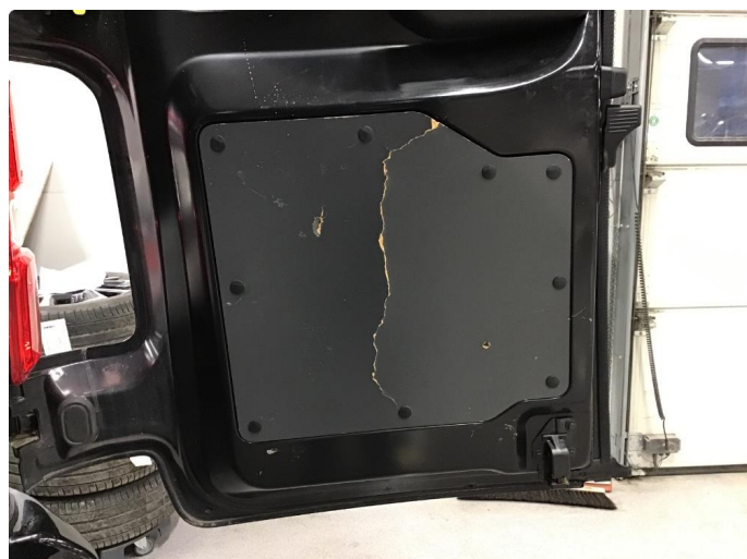
3.1 Noe brukslitasje i varerom
