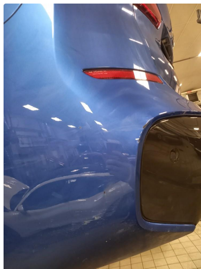
1.5 Støtfanger bak lakkeres før levering
