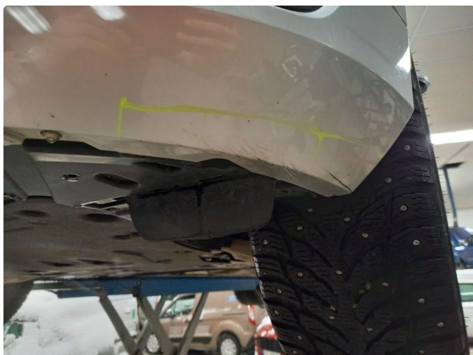
1.2 Nedre del støtfanger foran lakkert pga riper
