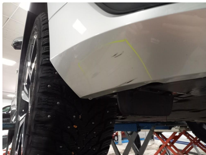
1.2 Nedre del støtfanger foran lakkert pga riper
