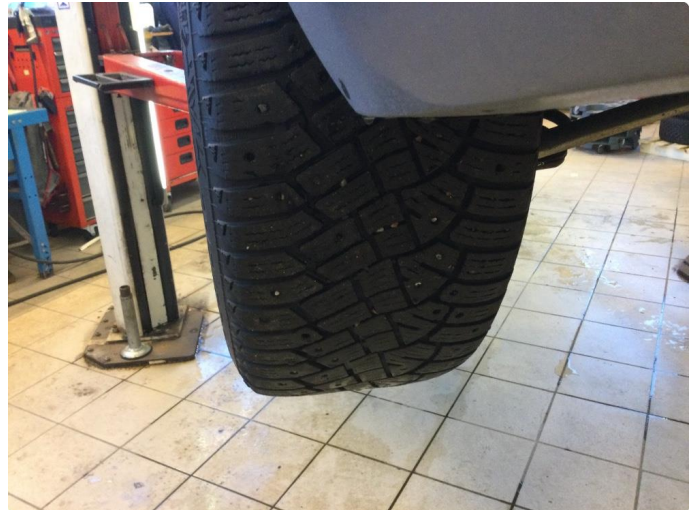
1.5 Piggdekk mangler pigger
