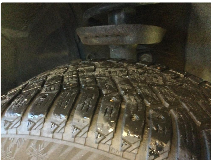
1.5 Piggdekk mangler pigger
