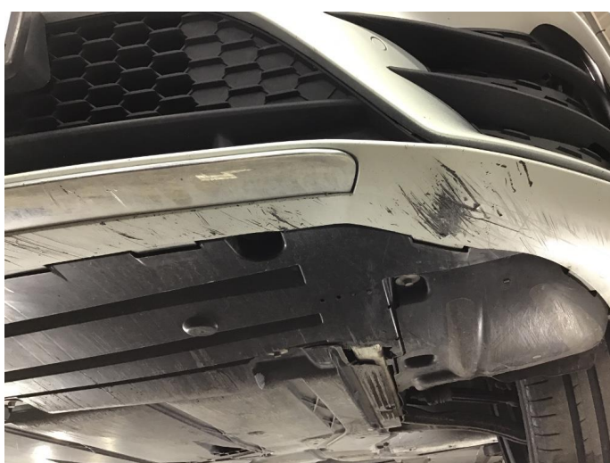
1.4 Skrubbskader i underkant av støtfanger
