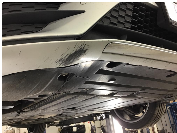
1.4 Skrubbskader i underkant av støtfanger
