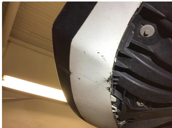
1.2 Normal bruksslitasje. Mindre riper under fanger foran.
