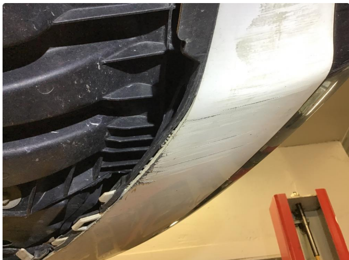
1.2 Normal bruksslitasje. Mindre riper under fanger foran.
