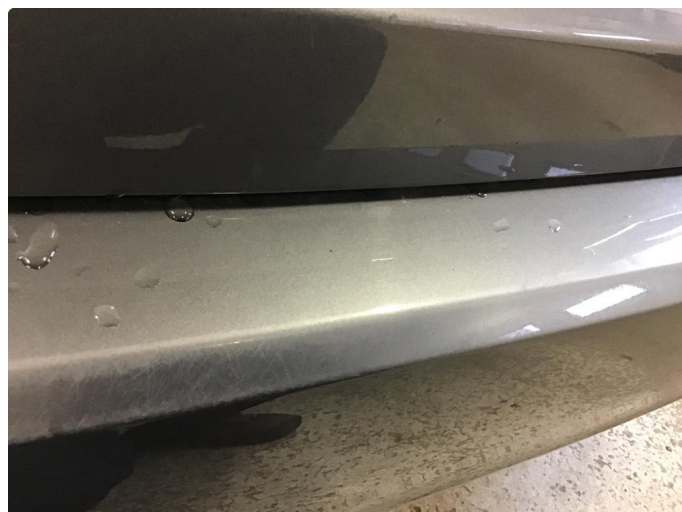
1.3 Noe slitasje i innlasting til varerom
