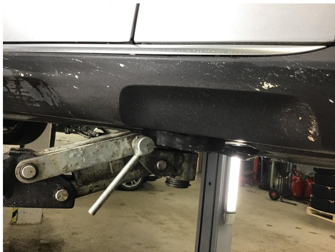
1.9 Maling fra asfalt på kanaler
