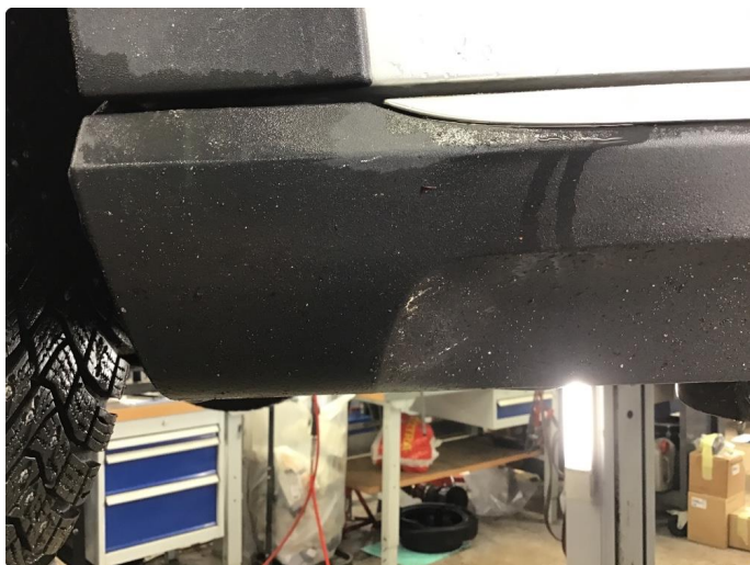
1.9 Maling fra asfalt på kanaler
