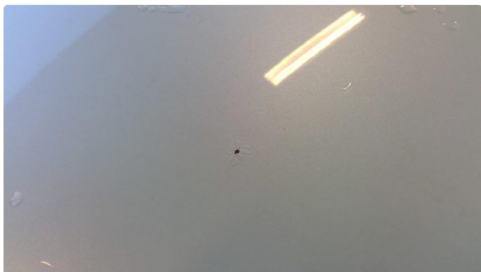
1.3 Steinsprut med rust
