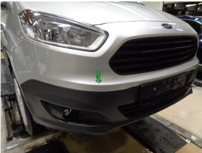
1.3 Ripe(r) ned til grunning
