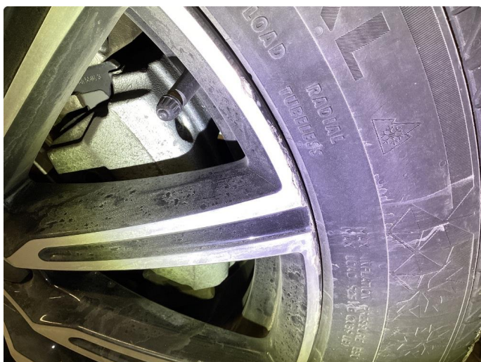
1.1 Kantkjørt felg.Blir byttet
