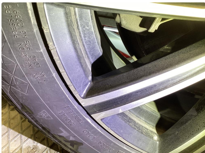
1.1 Kantkjørt felg.Blir byttet
