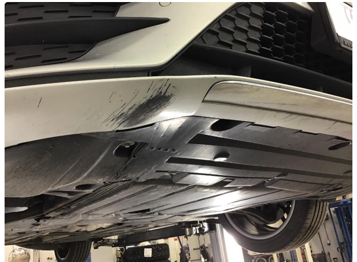
1.4 Skrubbskader i underkant av støtfanger
