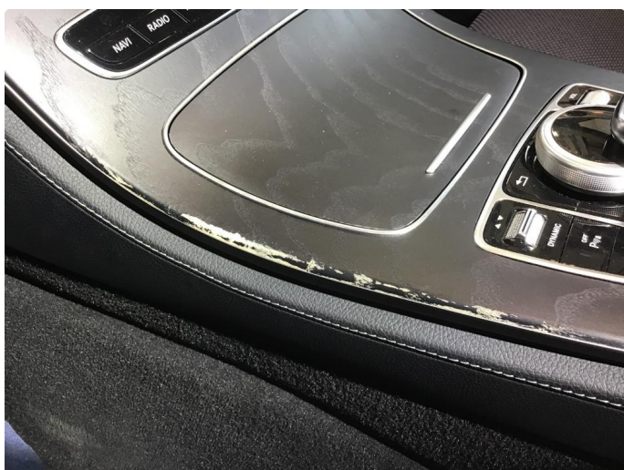
2.1 Missfarget / slitasje i kanter på midtkonsoll
