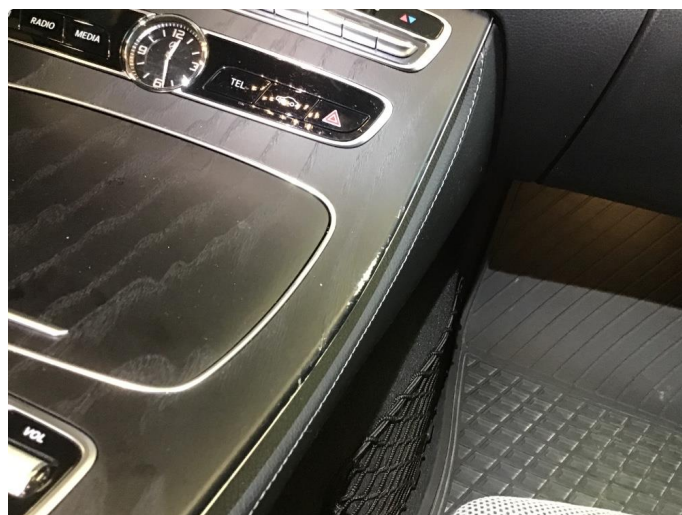
2.1 Missfarget / slitasje i kanter på midtkonsoll
