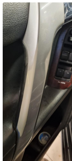
2.1 Lakk er slitt bort på inv dørhåndtak førerdør
