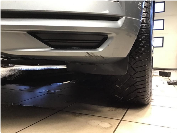
1.1 Liten subbeskade nedre del fanger foranforenklet lakk
