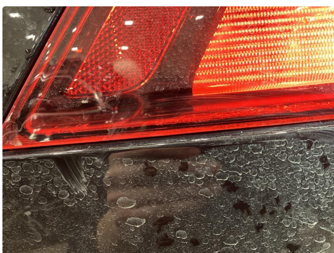
2.1 Krakelering i plast - Byttes på garanti
