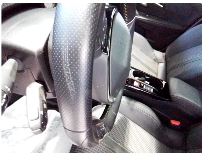
2.1 Slitasje på ratt
