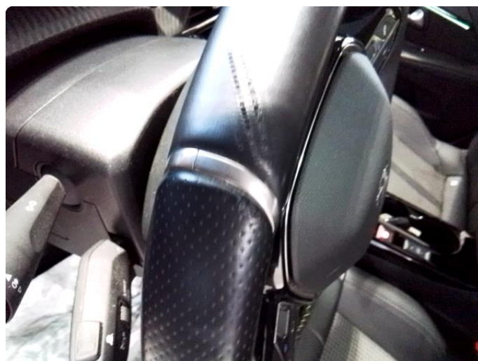
2.1 Slitasje på ratt
