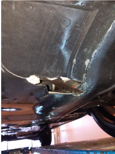
1.1 Noe skrape merke med liten sprekk på deksel under motor for støy.
