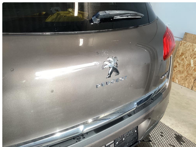
1.3 Store rustroser bakluke som er flekket. Bulk bakluke
