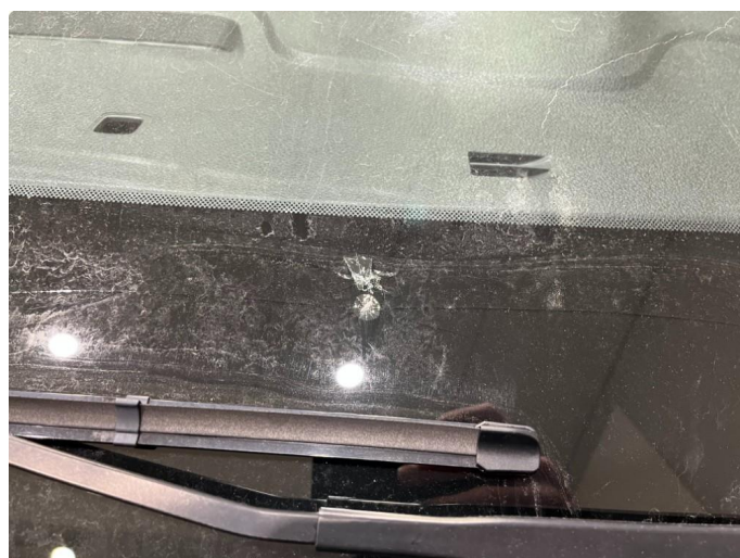
1.6 Ødelagt frontrute, må byttes
