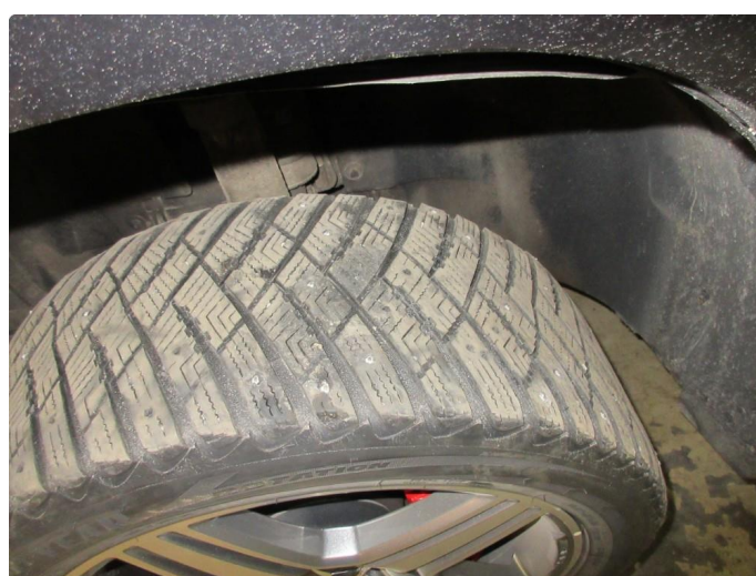
1.6 Piggdekk mangler pigger
