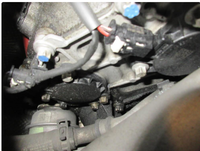
3.1 Oljelekkasje fra motor
