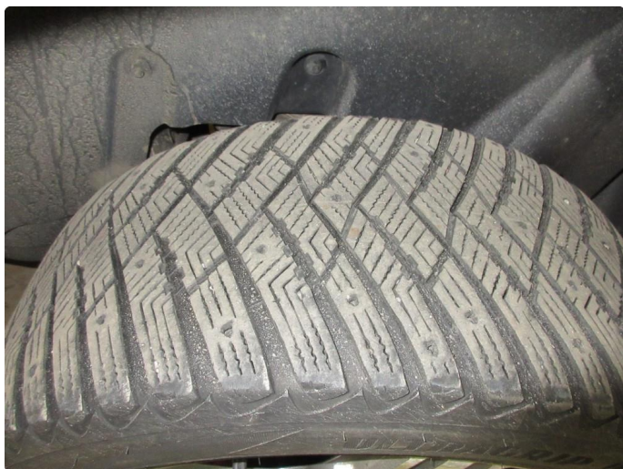
1.6 Piggdekk mangler pigger
