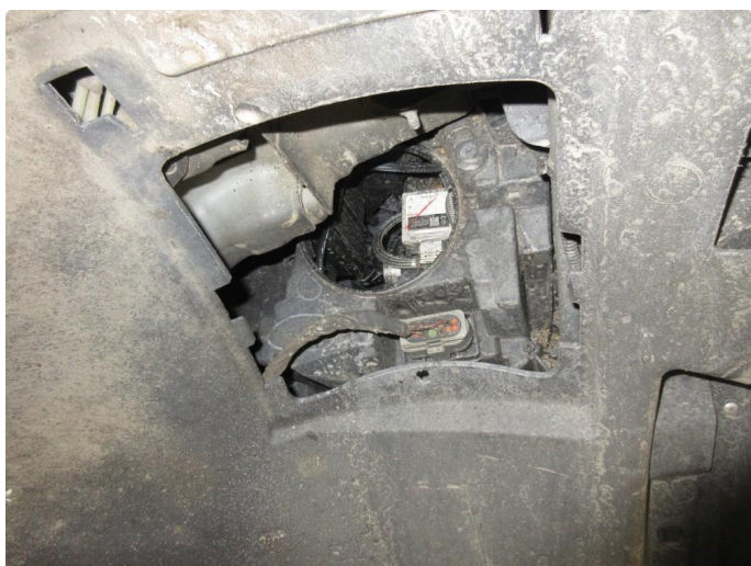
2.1 Lokk på lyshus mangler
